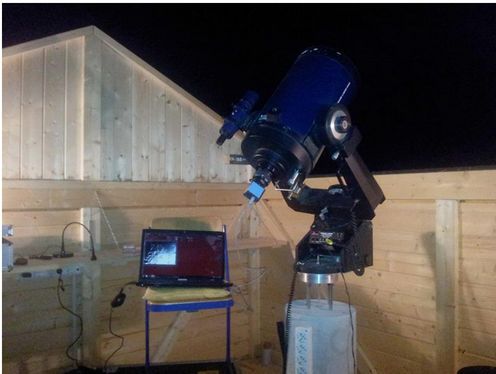
Das Teleskop (LX200 10" f=2500 mm) mit angeschlossenem Videomodul (TIS DMK21) mit Laptop
